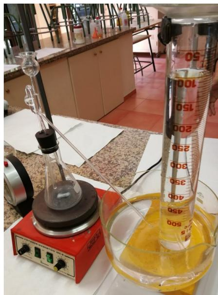
Se arranca el cronómetro cuando empiecen a subir burbujas de gas por la probeta invertida y se anotan los valores en una tabla Vol (cm<sup>3</sup>) frente a tiempo (s).
